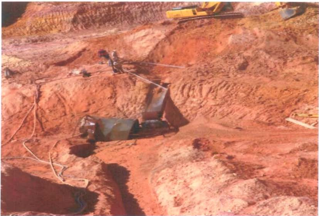
Figura 25 – Frente de lavra, com a utilização de água no transporte do material retirado.
