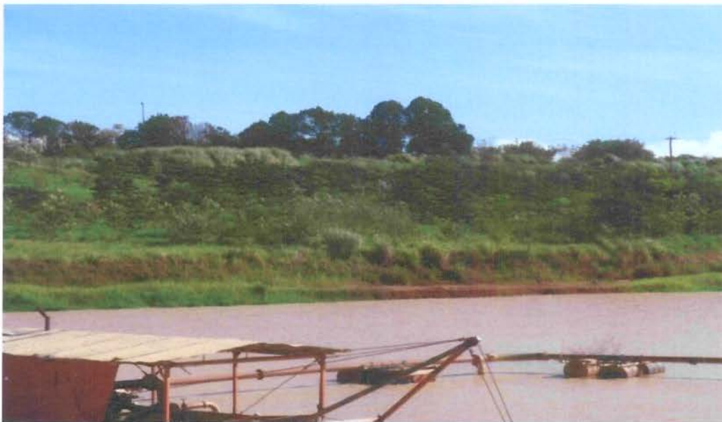
Figura 26 – Cava exaurida, utilizada como lagoa de decantação. Ao fundo, pode ser notado o plantio de espécies nativas em parte da cava já recuperada. A água é utilizada em circuito fechado e, quando necessário, ocorre a sua captação diretamente do Rio Capivari nas proximidades do empreendimento.
