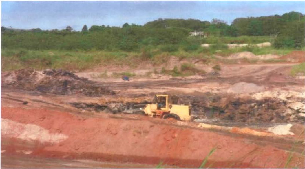
Figura 11 – Remoção de argila em cavas secas com pá carregadeira
