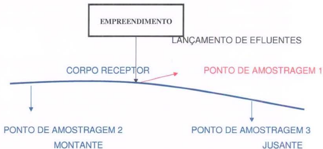
Figura 19 – Esquema de lançamento de efluentes em cursos d'água.
