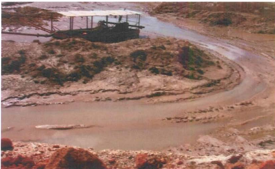
Figura 28– Draga posicionada no fundo da cava, utilizada para transporte de material até o beneficiamento. Pode-se notar que o lençol freático, nesse ponto, foi atingido.
