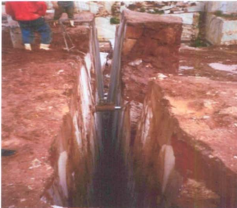
Figura 14 – Utilização de macaco mecânico no desmonte de rochas
