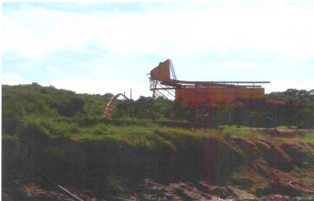
Figura 29 – Sistema de beneficiamento do material extraído. O material rejeitado, bem como a água utilizada no seu transporte são descartados na lagoa da figura 26.
