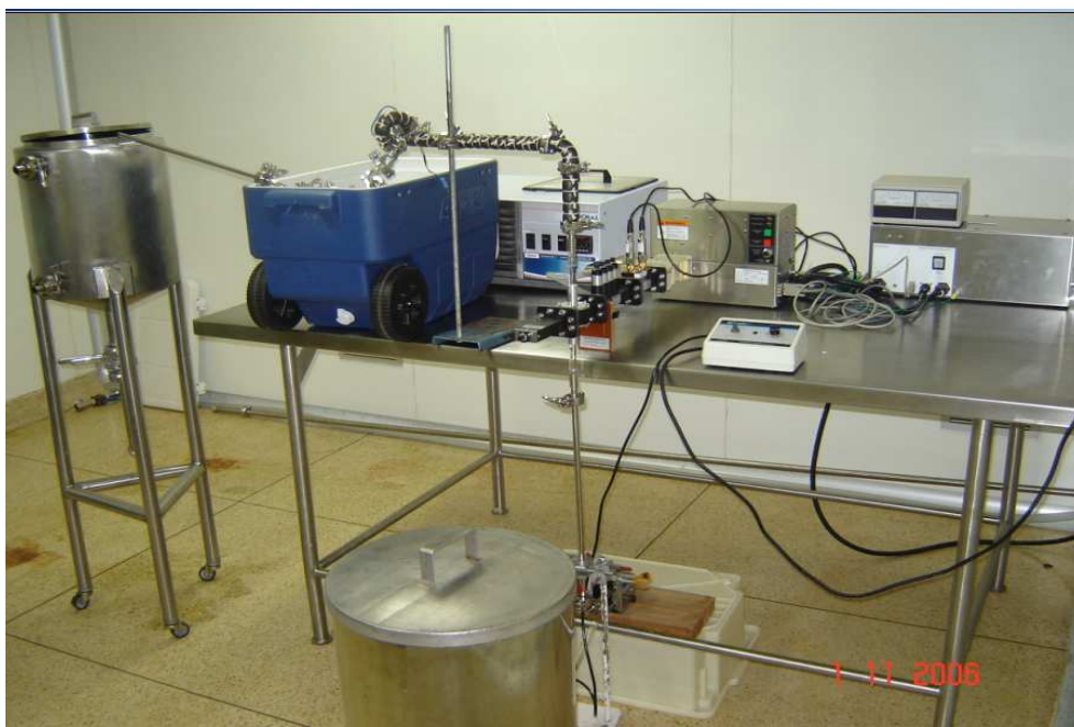
Figura 4.4 - Equipamento de microondas com capacidade para 9 L/h.
