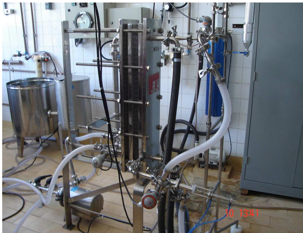
Figura 4.2 - Trocador de calor de placas com capacidade para 100 L/h.
