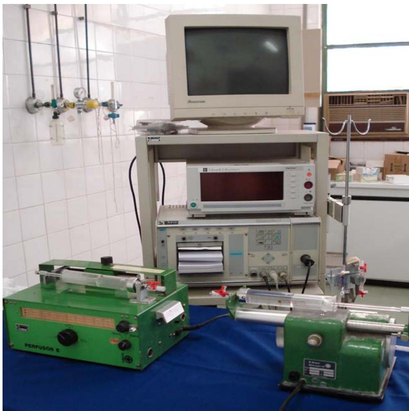
**Figura 13-** Bombas de infusão e polígrafo medidor da pressão de ruptura usados para o teste biomecânico.
