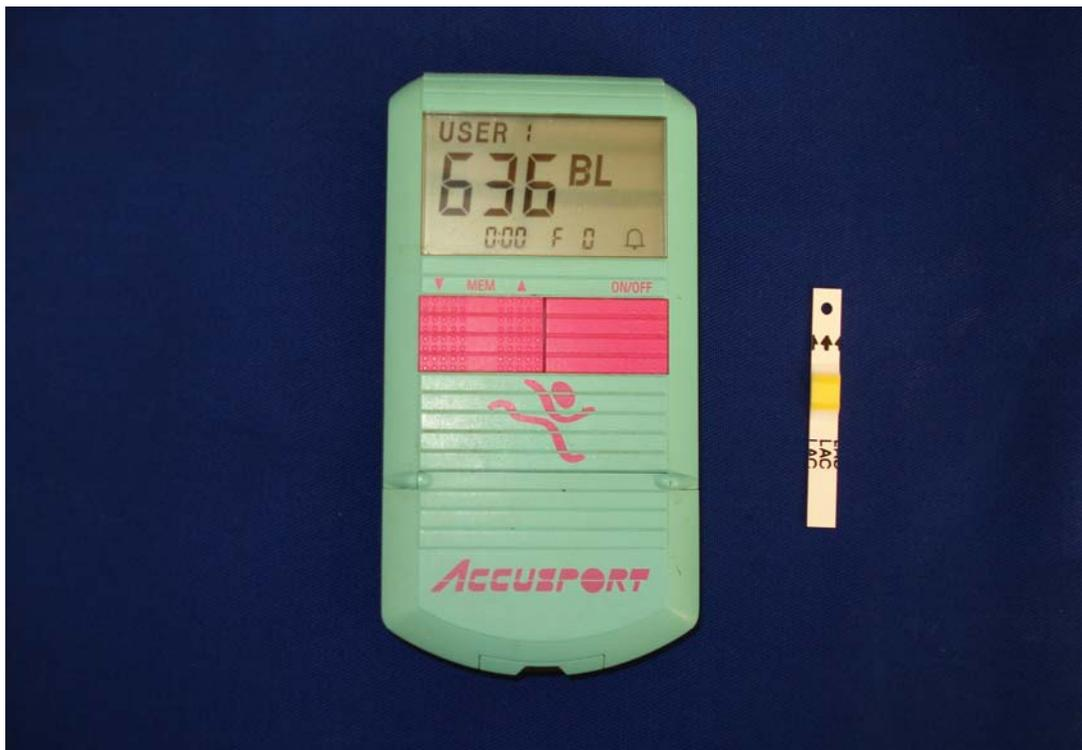
**Figura 5-** Lactímetro e fita dosadora.
