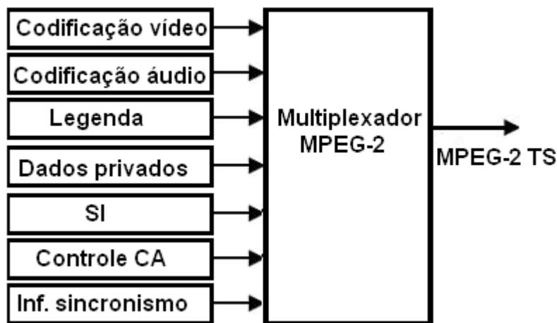
Figura 2.15 - Diagrama de blocos do MPEG-2 TS.
