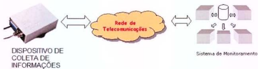
Figura 18. - Arquitetura básica de um sistema de telemetria Adaptado de (SILVA; MOREIRA, 2005)
