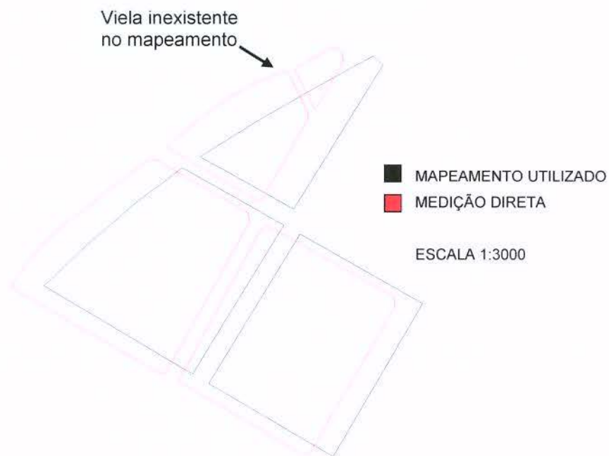
Figura 67. - Comparação do mapeamento utilizado com a medição direta.
