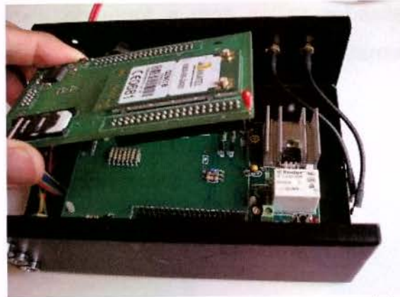
Figura 55. - Placa de interface (SIM Card e porta serial) Projetada em conjunto com a empresa CEBI Informatica. Estampada e montada pela empresa CADService de Campinas.
