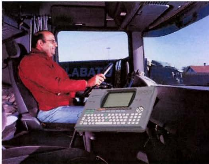
Figura 25. - Display e teclado para sistema AVL da empresa Qualcomm
