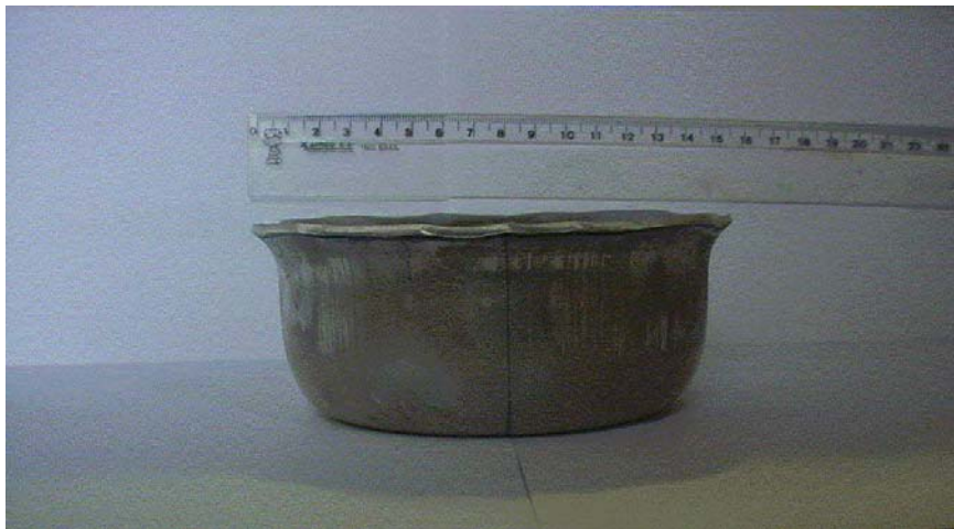
Figura 4.56 – Peça-teste da liga A5052 produzida a partir de chapa de 2,0 mm de espessura, no estado recozido, por estampagem profunda.
