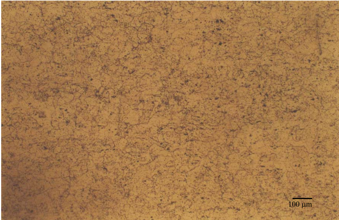
Figura 4.1 – Microestruturas da liga A5052 em diferentes condições: (a) chapa de 0,8 mm espessura, no estado laminado; (b) chapa de 2,0 mm espessura, no estado laminado; (c) chapa de 4,0 mm espessura, no estado recozido.
