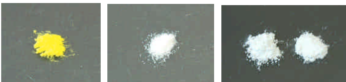
Fig. 2 – Demais reagentes: canforoquinona, dimetil-p-toluidina, cargas silanizadas de vidro de estrôncio (0,7 e 2 \mu m).
