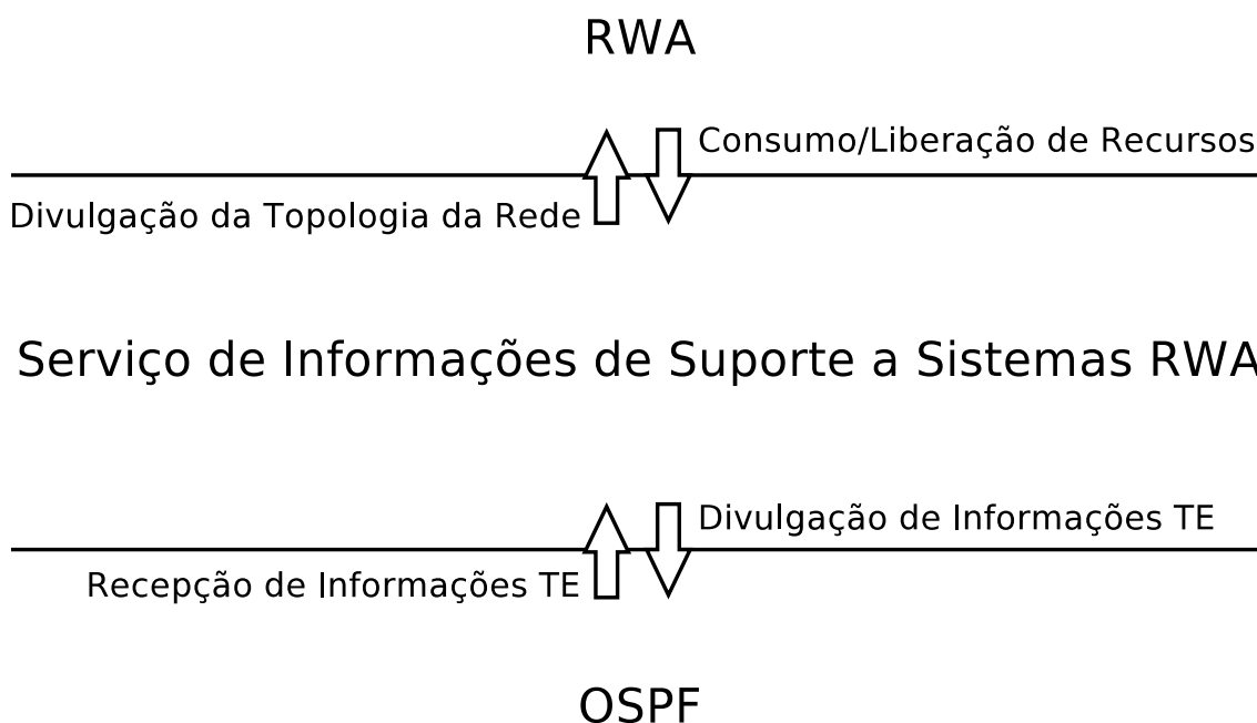
Fig. 4.1: Cenário de aplicação do Serviço de Informações de Suporte a Sistemas RWA.
