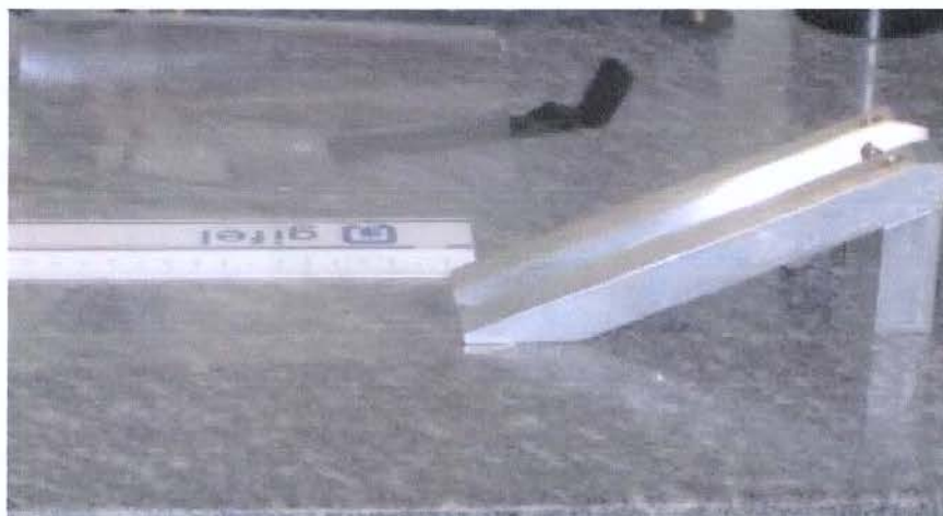
Figura 35: Ensaio de “rolling ball” (“tack”)
