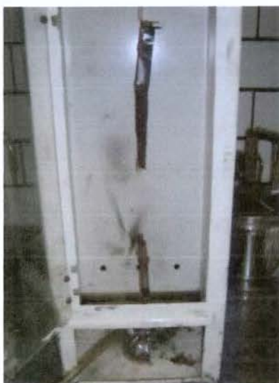
Figura 36: Equipamento para ensaio de resistência à propagação de chama
