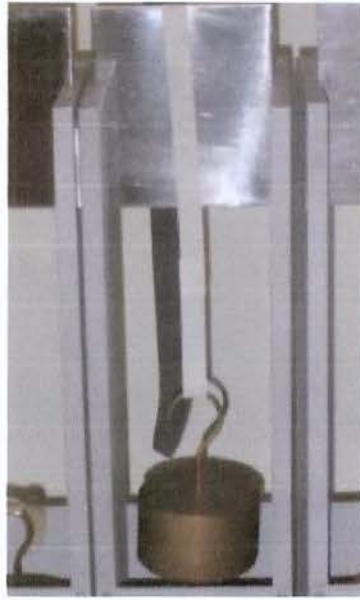
Figura 34: Ensaio de “bond” (coesão)
