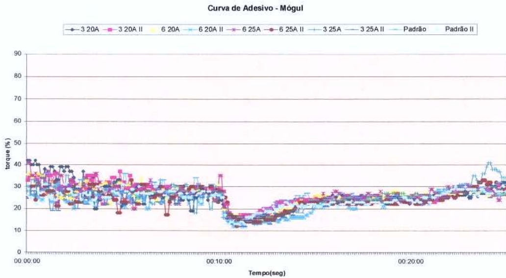
Figura 44: Curvas de torque dos adesivos (Mógul)
