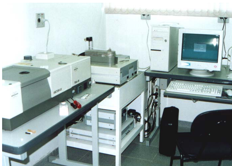
Figura 10 – Equipamento de Análise termogravimétrica (TGA) acoplado ao equipamento de espectroscopia de infra-vermelho com transformada de Fourier, marca Bruker modelo Vector 22.
