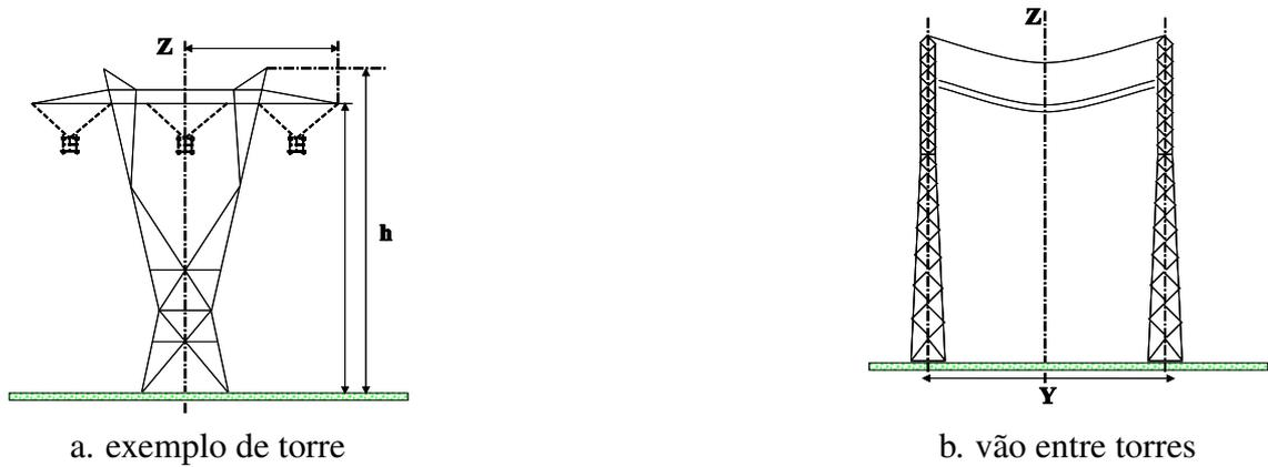
Fig. C.1: Representação de linhas elétricas (para estudos de propagação)
