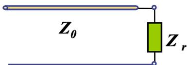
Fig. A.1: Coeficiente de reflexão
