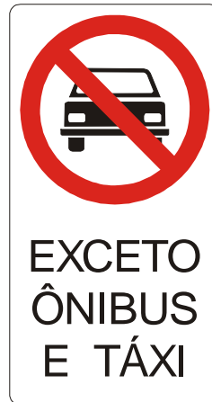
Figura 4.8 – Exemplo de sinal de regulamentação que estabelece tipo de veículo com permissão de circulação na via
