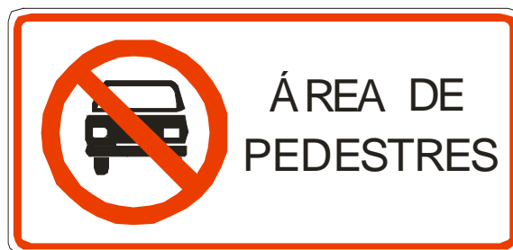
Figura 4.6 – Exemplo de sinal de regulamentação que proíbe a circulação de veículos automotores
