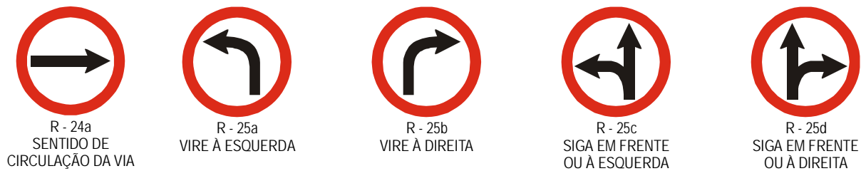
Figura 4.9 – Exemplos de sinais de regulamentação de circulação na via
