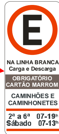
Figura 3.11 – Exemplo de sinal de regulamentação de estacionamento rotativo pago – Zona Marrom
