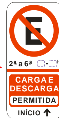
Figura 3.9 – Exemplo de utilização de regulamentação de estacionamento para carga e descarga com restrição de horário
