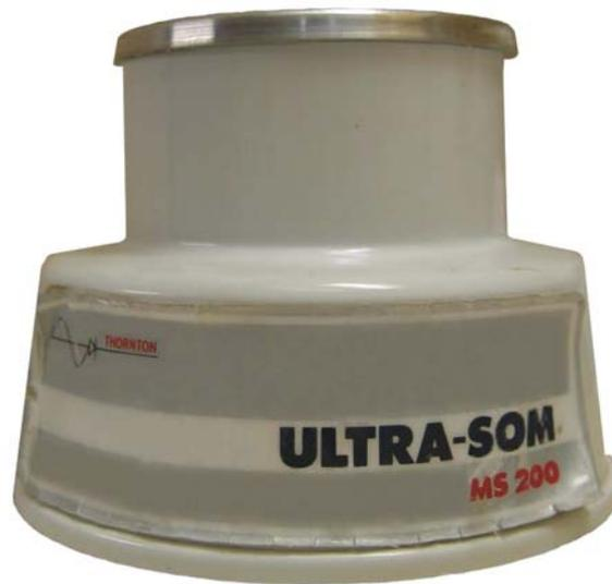
*Figura 13 – Aparelho de ultra-som (MS 200) utilizado para limpeza final dos braquetes e fios ortodônticos.*
