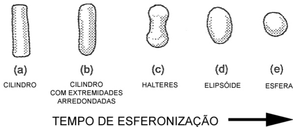
FIGURA 49. Representação das transições de forma das partículas durante a esferonização: partículas cilíndricas (a), cilíndricas com extremidades arredondadas (b), halteres (c), elipsóides (d) e esferas (e) (adaptação de SUMMERS & AULTON, 2001).
