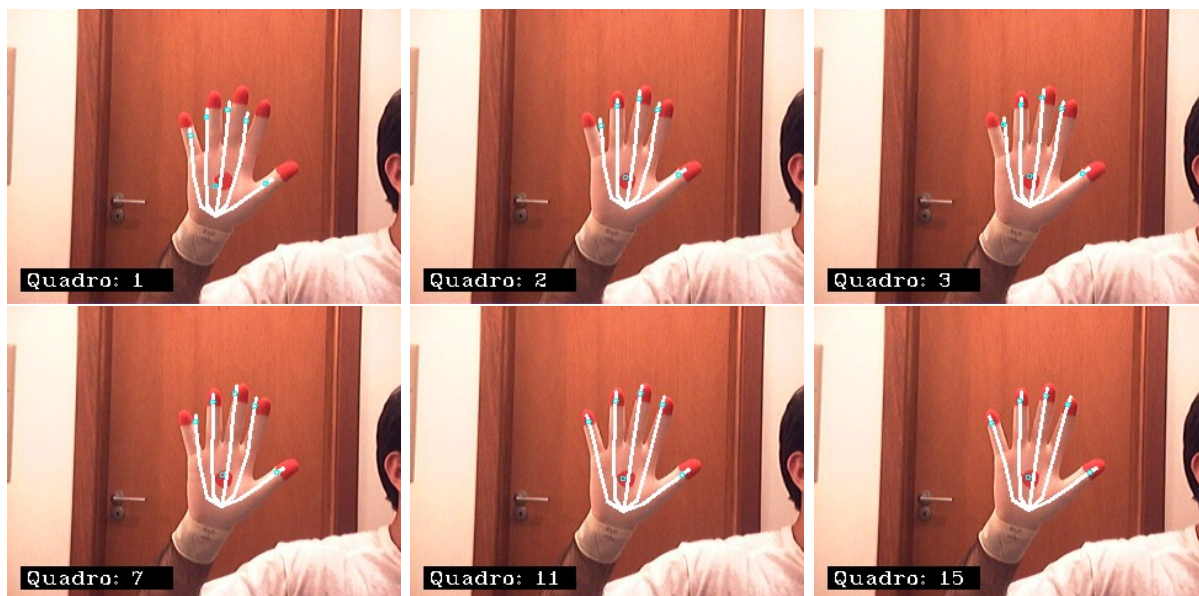
Figura B.1: Seqüência usada no ajuste inicial do vídeo “Dedo”. Cada quadro mostra a imagem original com a projeção da estimação sobreposta.
