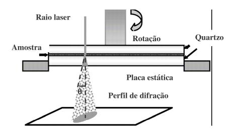
Figura 8. Desenho esquemático da técnica Reo-SALS.
