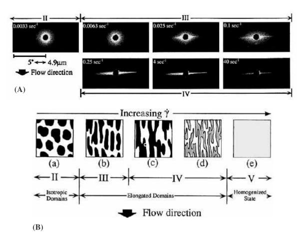
Figura 9. (A) Perfil de SALS e (B) esquema da microestrutura de sistemas poliméricos bifásicos sob cisalhamento. Os regimes II, III e IV são obtidos para taxa de deformação menor do que a crítica para mistura (Kume et al., 1995).
