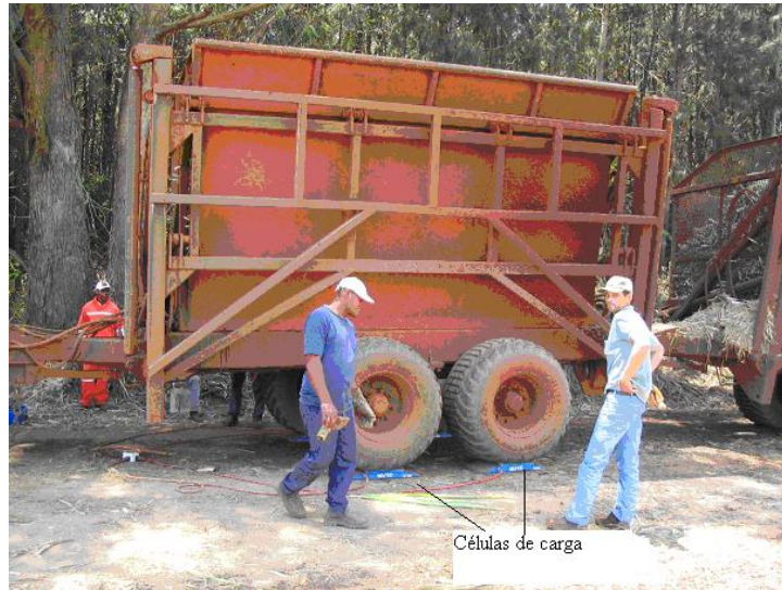
Figura 35. Pesagem do transbordo utilizando células e carga.
