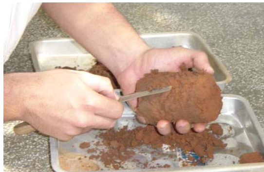
Figura 19. Remoção da superficial lateral das secções de solo para evitar uma possível contaminação com óleo.
