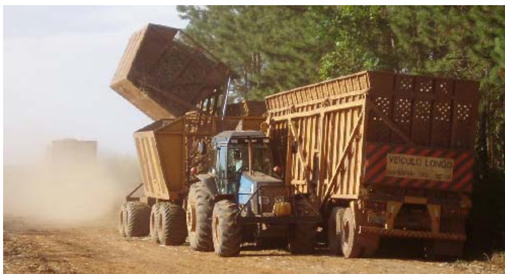
Figura 53. Carga dos transbordos sendo transferida para o “rodotrem”.
