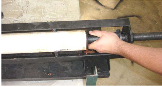
Figura 16. Detalhes do procedimento de remoção de amostras de solo (“Saca amostra”).
