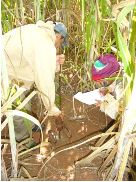
Figura 13. Determinação da resistência do solo à penetração.
