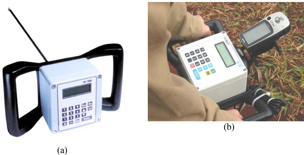
Figura 15. Equipamento utilizado para avaliar a resistência a penetração do solo: (a) Penetrômetro DLG, (b) detalhe do penetrômetro com o GPS acoplado.
