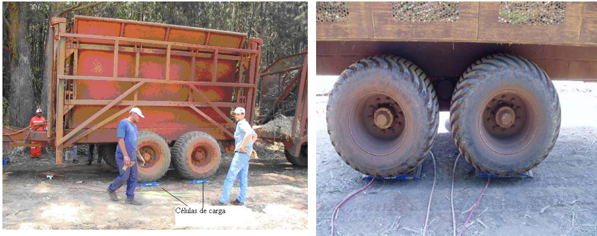
Figura 59. Pesagem do transbordo utilizando células e carga.
