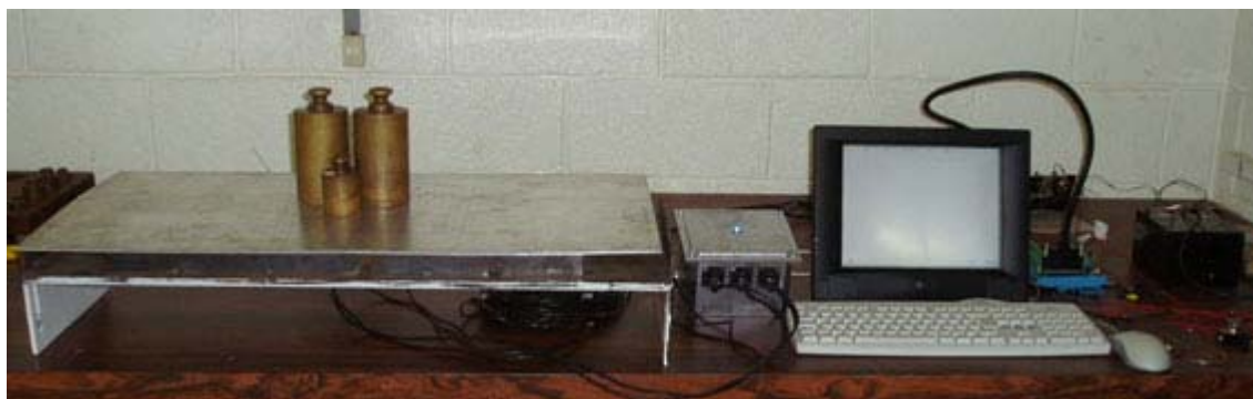
Figura 52. Ensaio de calibração da balança em condições de laboratório.
