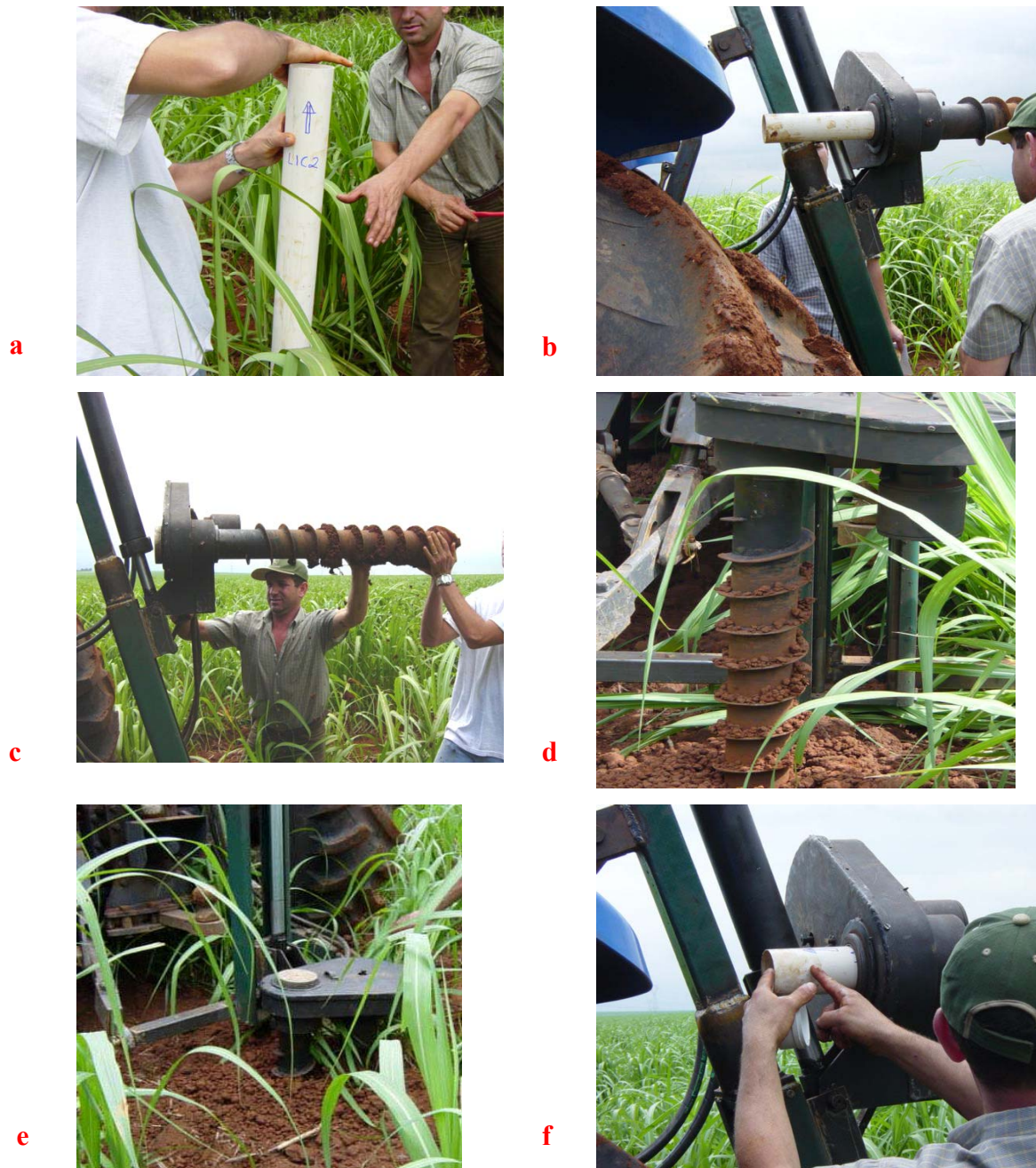
Figura 12. Etapas da coleta de solo. a) Numeração e aplicação de uma película de óleo no tubo; b) Colocação do tubo no amostrador; c) Destravamento da sonda para posição vertical; d) Penetração do amostrador no solo; e) Outra vista da penetração do amostrador no solo; f) Retirada do tubo com solo do amostrador e colocação da tampa de vedação do tubo.
