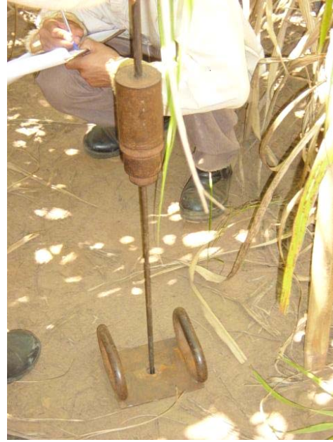
Figura 13. Determinação da resistência do solo à penetração.
