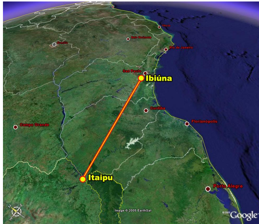
Figura 1.5: Itaipu, exemplo brasileiro da grande distância entre as fontes de geração hidrelétrica e os centros de consumo (Fonte: Google Earth).
