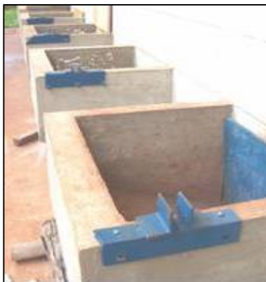
Figura 8. Gabarito para fixação e alinhamento dos colmos de bambu.
