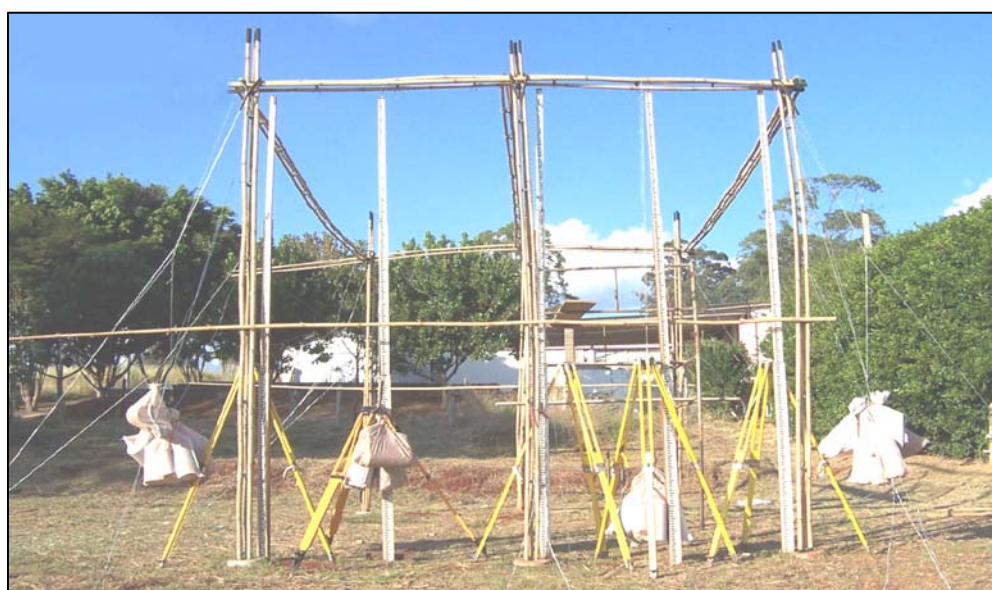
Figura 10. Croqui da distribuição das cargas aplicadas e os pontos de medição para variação do deslocamento vertical no pórtico longitudinal.
