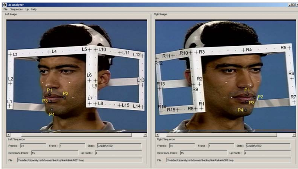
Fig. 5.6: Pontos de referência ( L_i e R_i , i = 1, 2, \dots, 15 ) utilizados para a calibração das câmeras e os pontos de interesse ( P_1 a P_4 ).
