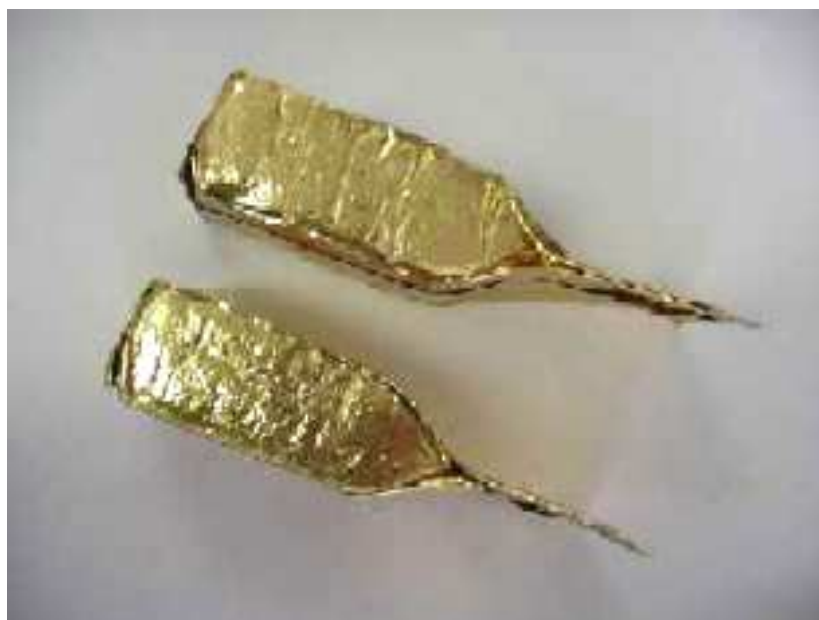
FIGURA 1. Protótipos de embalagens de café torrado e moído unitizadas acondicionadas sob vácuo.
