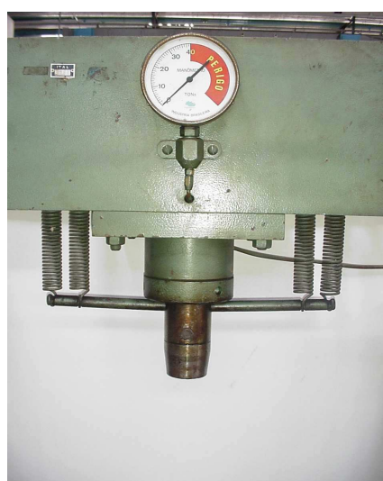
FIGURA 2. Detalhe do cabeçote da prensa utilizada na prensagem do café.
