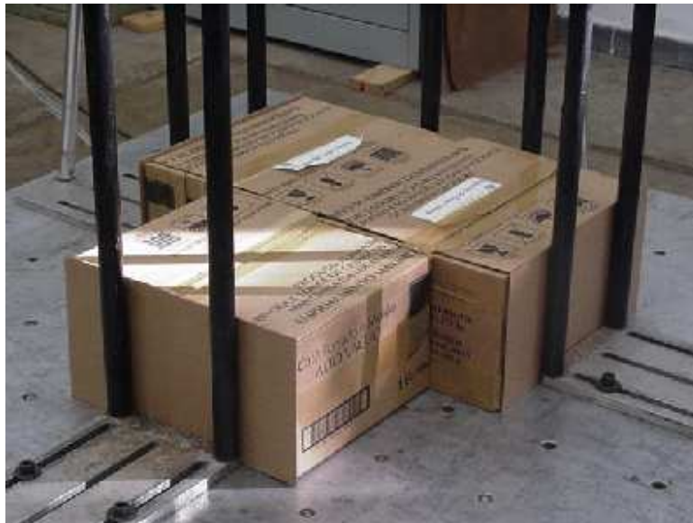
FIGURA 5. Arranjo das caixas de café prensado sobre a mesa de vibração
