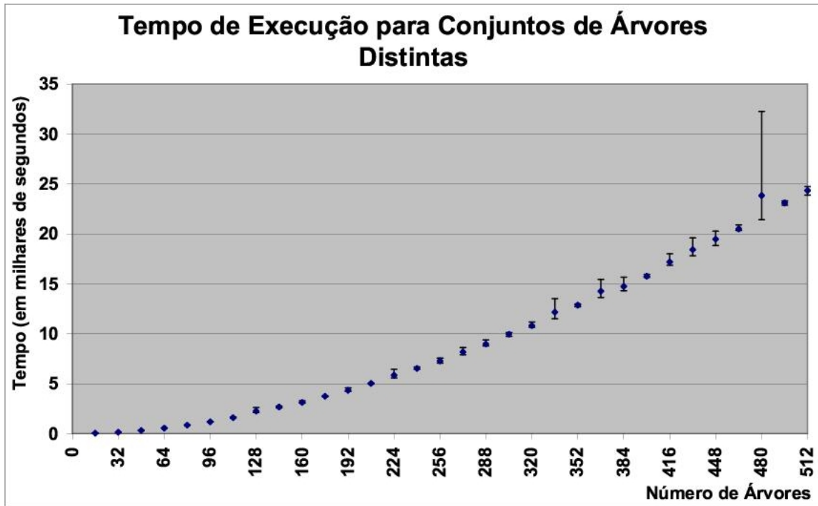
Figura 6.7: Tempo de execução do algoritmo para coleções de árvores distintas. No exemplo, apenas o número t de árvores varia, sendo o número l de folhas uma constante. Note que os tempos são da ordem de horas. Barras inferiores e superiores indicam, respectivamente, o menor e o maior tempo observados.
