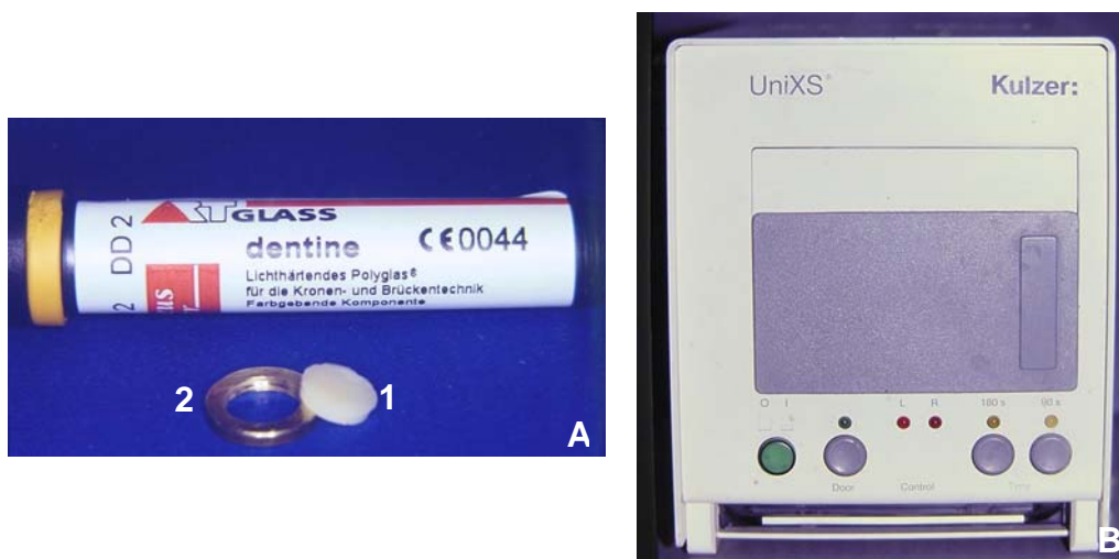
Figura 1A - Disco do compósito Artglass (1) obtido em matriz metálica (2); 1B. Aparelho fotoativador UniXS.
