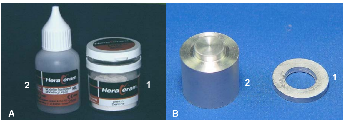
Figura 2 - A - Pó cerâmico (1) e líquido modelador (2). B - Matriz metálica (1) e dispositivo para remoção (2) do disco cerâmico pré-sinterização.
