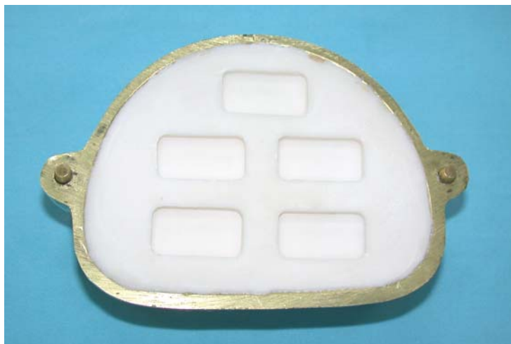
Figura 7 – Moldes das matrizes impressos na contra-mufla
