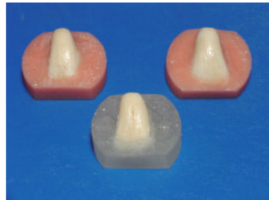
Figura 9 – Amostras prontas para a planificação do esmalte.
