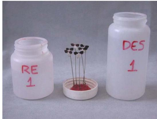
**FIGURA 12** – frascos plásticos devidamente numerados e identificados com as soluções DES-RE utilizadas na ciclagem de pH.
