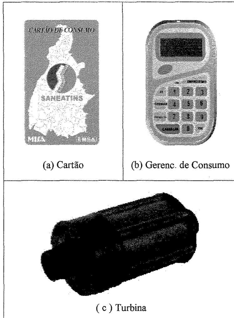
Figura 3.15 Componentes do sistema de fatura eletrônica do consumo de água.
