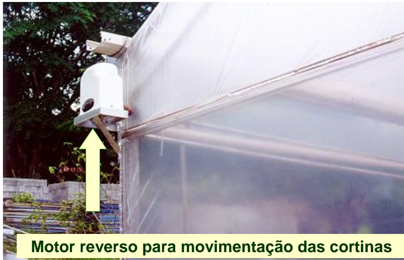
Figura 23. Motor reverso: movimentação das cortinas termo refletoras.
