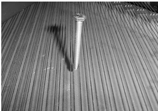
Fig. 6 - Parafuso (bolt) posicionado entre as cordas 2 e 3 do sistema. Situação P2-3.
