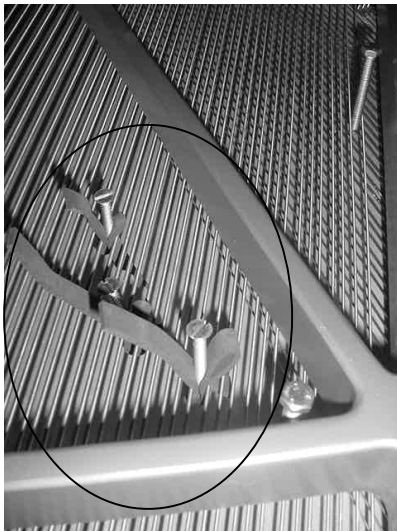
Fig. 13 – Parafusos encapados com material mole na região grave do piano (Spontaneous Earth, 1944)
