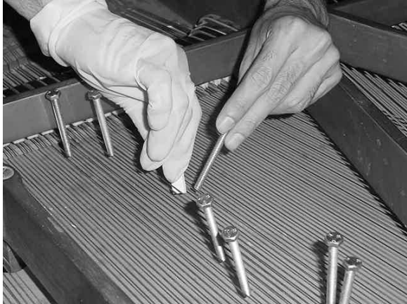
Figs. 4 e 5 – Preparação com luva de borracha e alavanca de preparação .
