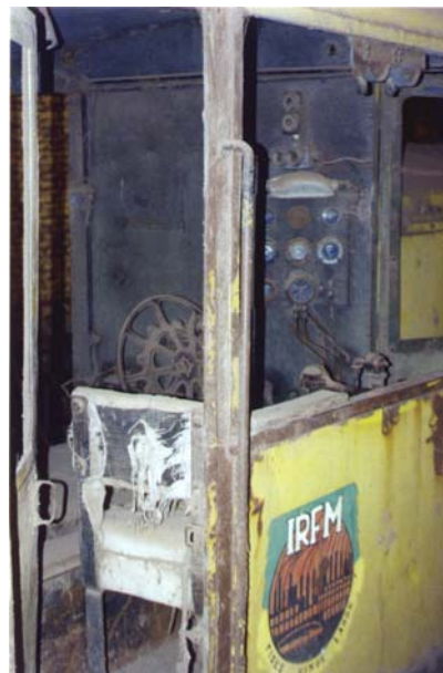
Uma das locomotivas da indústria Matarazzo, movida por um motor de 8 cilindros em V, fabricada nos Estados Unidos pela Davenport. O seu modelo é o 017000. Rancharia, julho 2002. Foto do autor.
