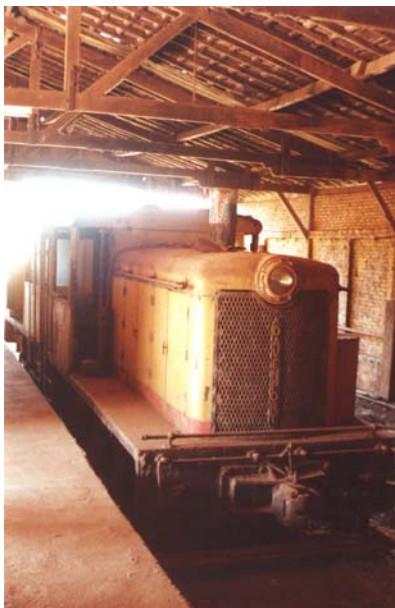
Uma das locomotivas da indústria Matarazzo, movida por um motor de 8 cilindros em V, fabricada nos Estados Unidos pela Davenport. O seu modelo é o 017000. Rancharia, julho 2002. Foto do autor.
