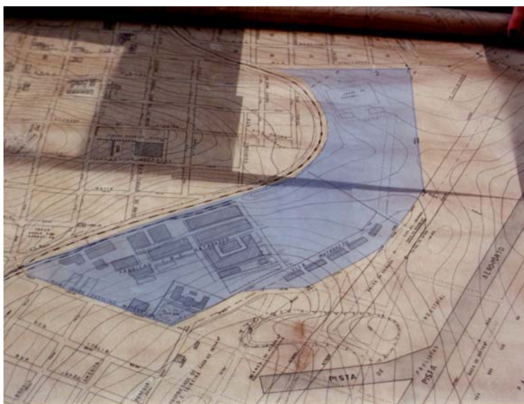
Planta topográfica de Rancharia, sem escala e sem data. Todo o núcleo fabril de algodão Matarazzo está compreendido no destaque em azul. Vê-se, nesta planta, ao lado da Matarazzo, a estrada de rodagem e a pista do antigo aeroporto; do outro lado, a Estrada de Ferro Sorocabana. Fonte: Arquivo da Esteve S/A.
