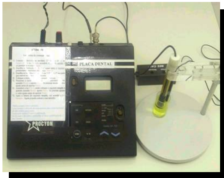
A- pHmetro, microeletrodo Beetrode® e eletrodo de referência.
