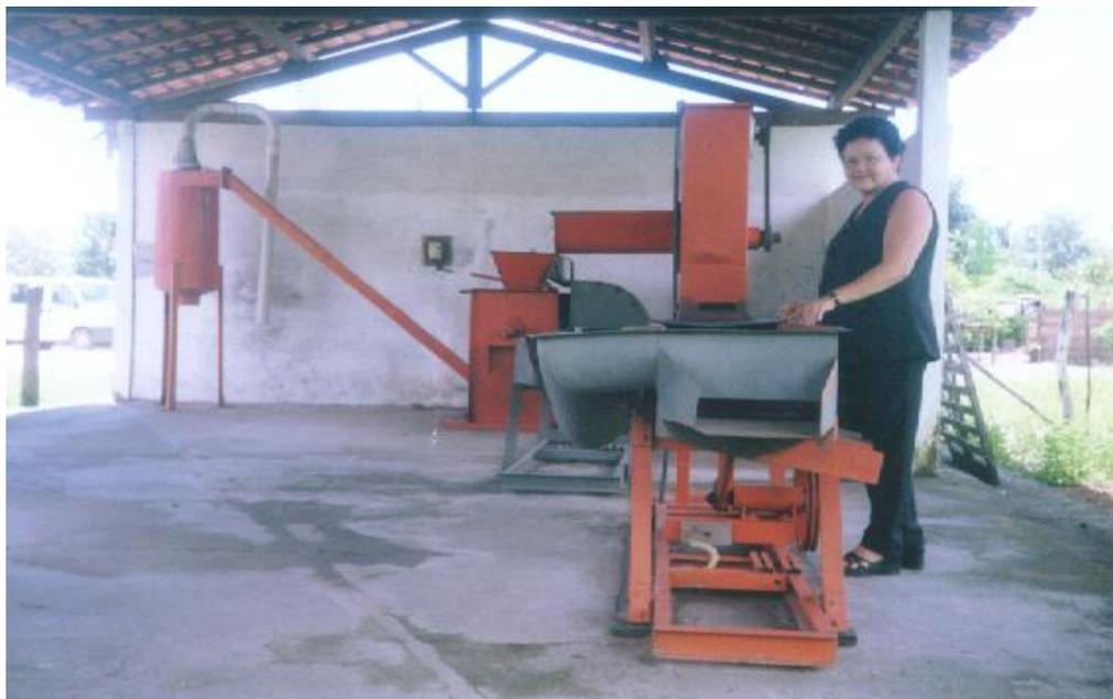
Figura. 2.8: Máquina de descascar e quebrar coco instalada no município de Itapecurú-Mirim. (foto do autor).
