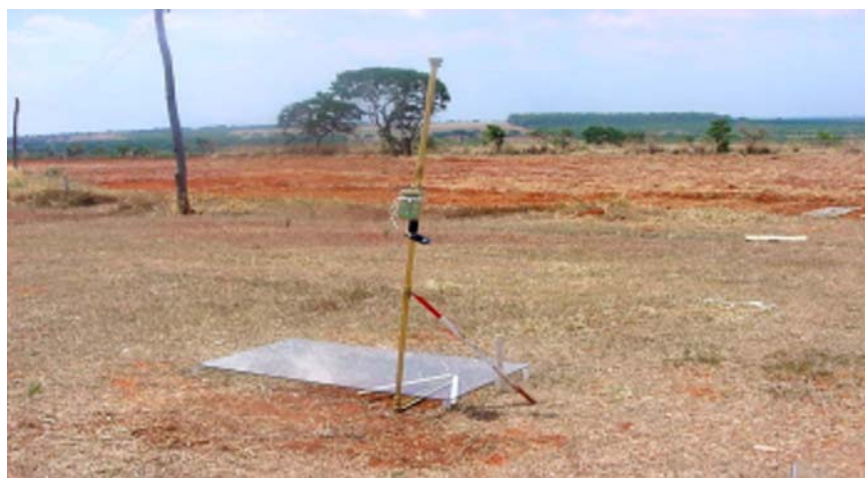
Figura 3.8. Placa de vidro com área de 0,75 m 2 e os sensores usados na medição da radiação solar interceptada pela palhada.
