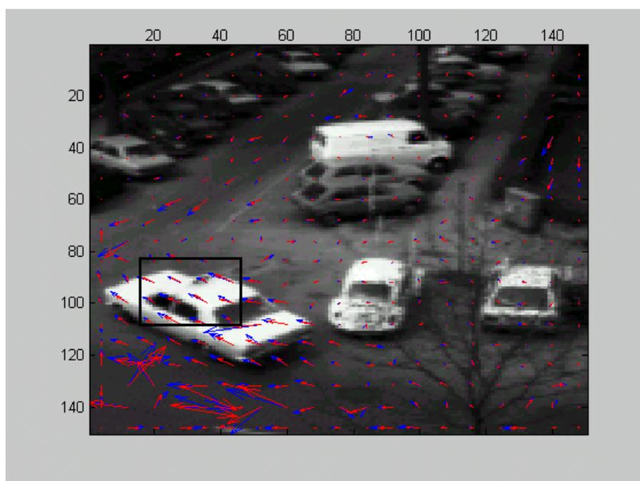
**Figura 7-13** : Um dos quadros da seqüência “Hamburg Taxi” e os mapas de fluxo resultantes utilizando-se o mínimo erro quadrático (em azul) e utilizando-se o mínimo erro quadrático ponderado (em vermelho). O retângulo tracejado indica a região ampliada e mostrada na figura seguinte.
