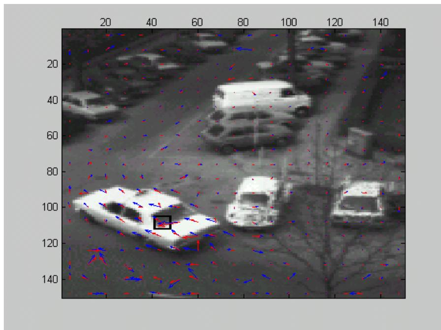
**Figura 7-22:** Um dos quadros da seqüência “Hamburg Taxi” e os mapas de fluxo resultantes utilizando-se o mínimo erro quadrático ponderado (em azul) e utilizando-se o mínimo erro quadrático com eliminação de valores aberrantes (em vermelho). O bloco identificado por um retângulo ( $\text{blocox}=6$  e  $\text{blocoy}=14$ ) foi o utilizado para ilustrar a construção do gráfico de caixa.
