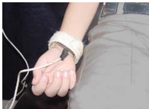
FIGURA 07 – Colocação e fixação de eletrodo de referência em voluntário
