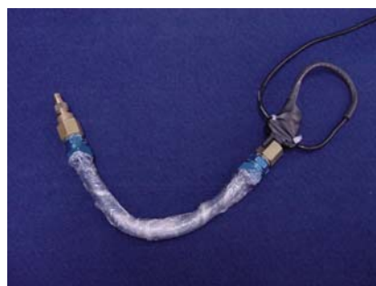
Figura 10. Tubo transmissor protegido
