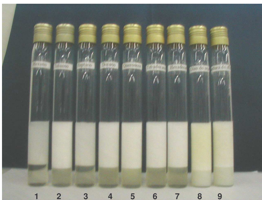
Figura 19. Atividade emulsificante (E 24 ) de solução de biosurfatante LB5a frente a diferentes hidrocarbonetos. (1) Hexano, (2) Tolueno, (3) Heptano, (4) Decano, (5) querosene, (6) Tetradecano, (7) Hexadecano, (8) Óleo de soja, (9) Gordura de côco.
