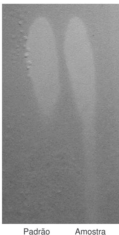
Figura 14. Cromatografia em camada delgada do padrão de surfactina e da amostra semi-purificada do surfatante obtido por B. subtilis LB5a em manipueira.
