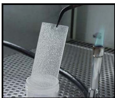
D - Transferência das lâminas com Biofilme formado, para tubos cônicos
