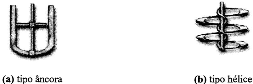
**Figura 24:** Impelidores utilizados no escoamento laminar.
