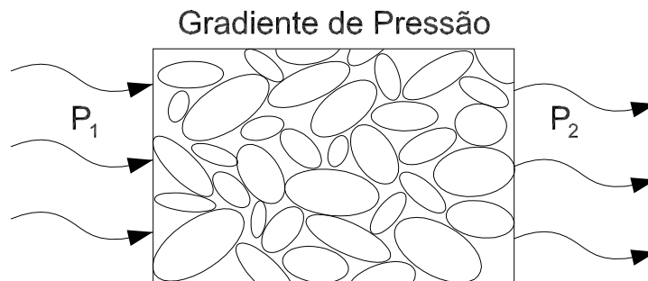
Figura 3.2: Comportamento macroscópico de um fluxo sobre um material poroelástico
