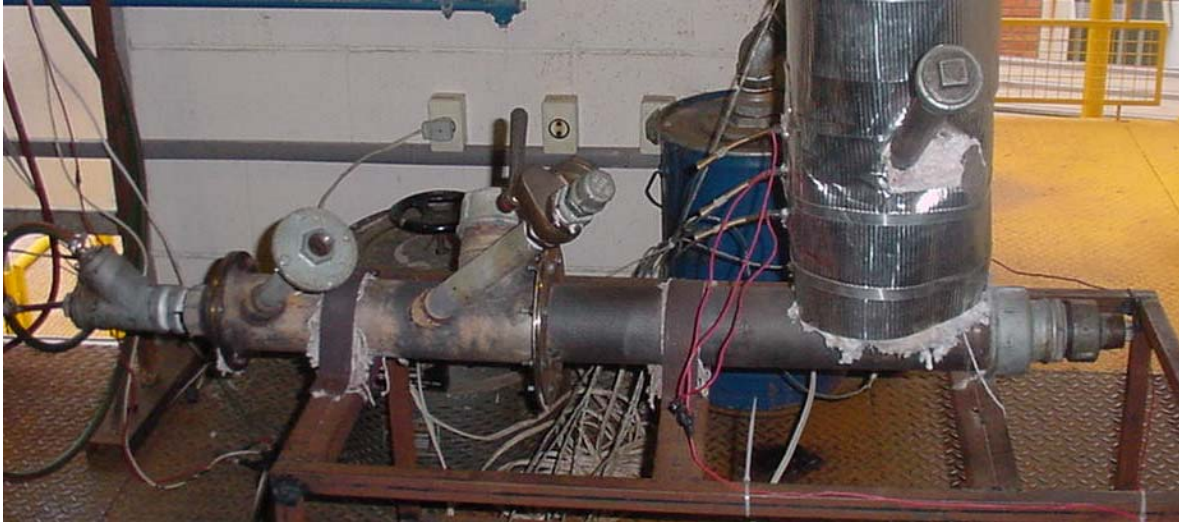
Figura 5. 10: Visão Geral do Queimador
