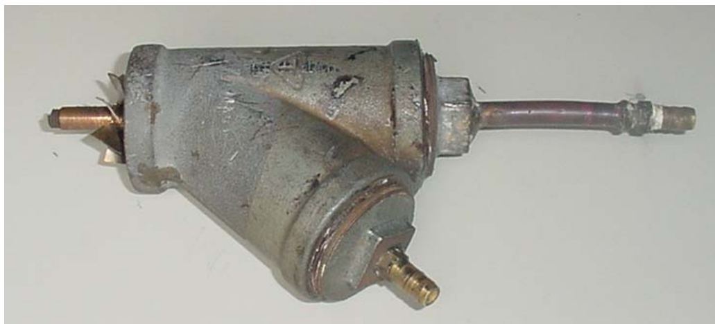
Figura 5. 7: T de 45 °usado para misturar os gases
