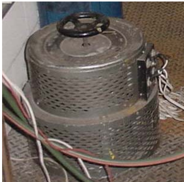
Figura 5. 12: Controlador de Tensão
