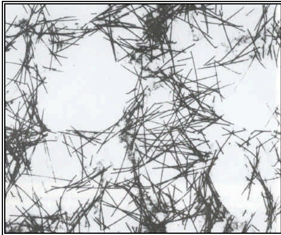
Figura 2.5: Distribuição não uniforme das fibras de aço no concreto, observado por raios X (Bentur e Mindess, 1990).
