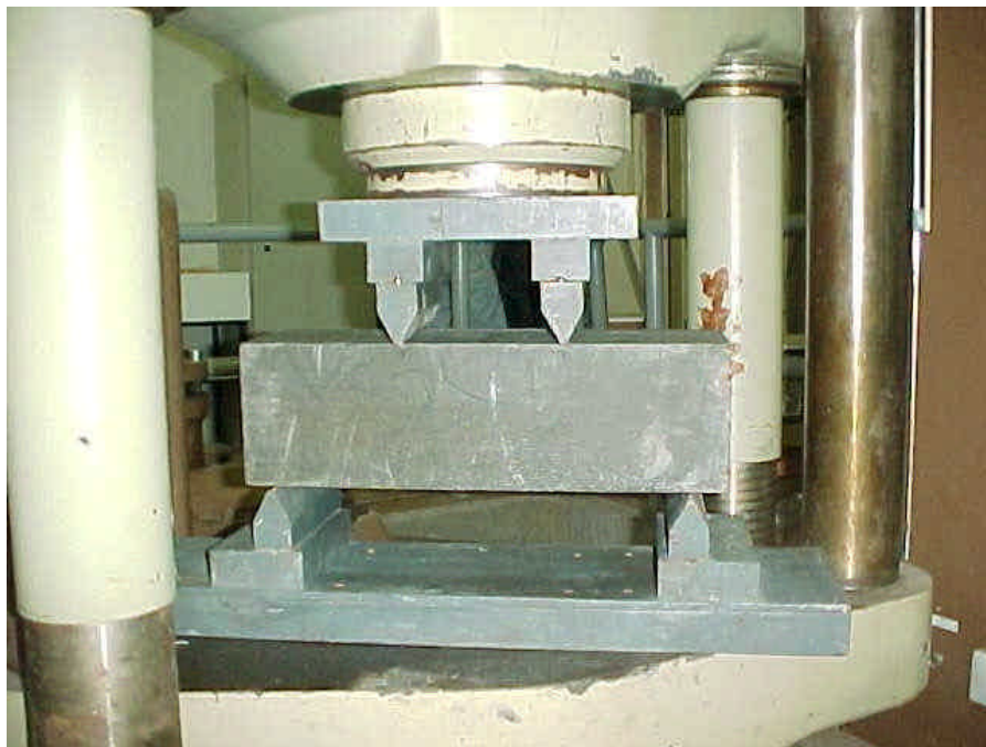
Figura 3.11: Ensaio de resistência à tração na flexão (ASTM C78 – 94).
