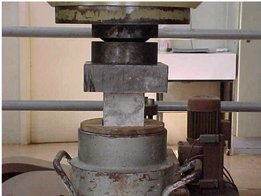
Figura 3.9: Ensaio de resistência à compressão (ASTM C 109-93 adaptada).
