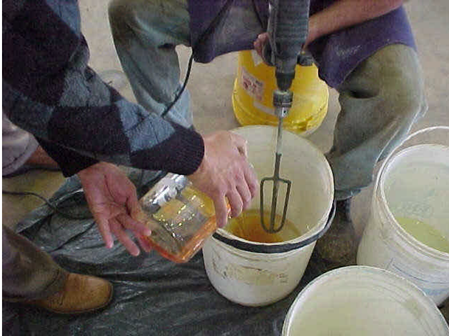
Figura 3.13: Mistura dos componentes líquidos.
