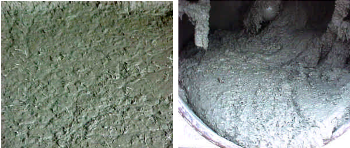
Figura 3.17 - Fluidez da mistura e homogeneidade das fibras de aço.
