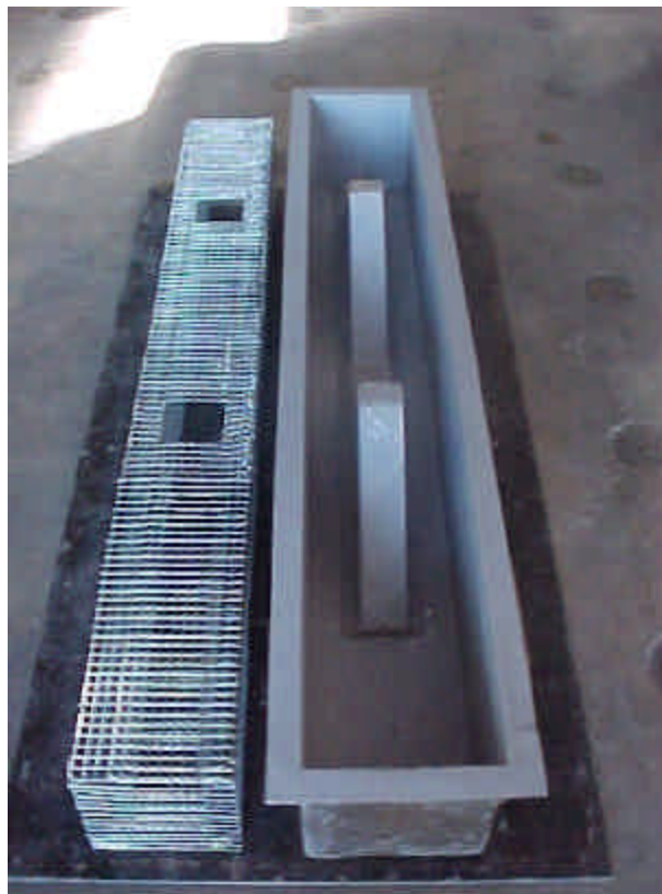
Figura 3.16 – Molde de fibra de vidro e a armadura em forma de tela.
