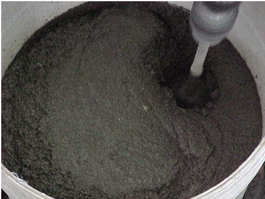
Figura 3.14: Mistura dos componentes líquidos com os agregados.
