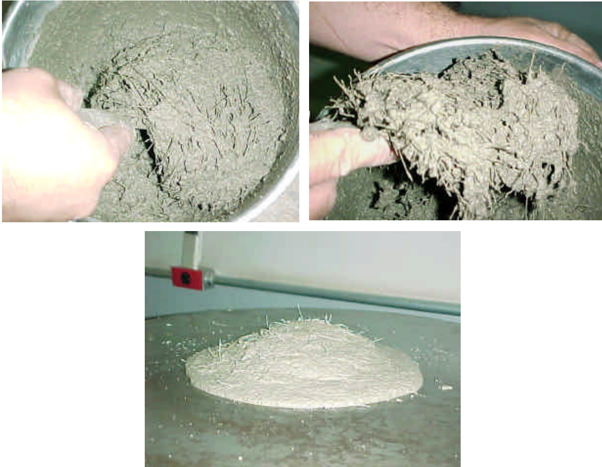
Figura 3.8: Consistência da argamassa com 3 % de fibras
