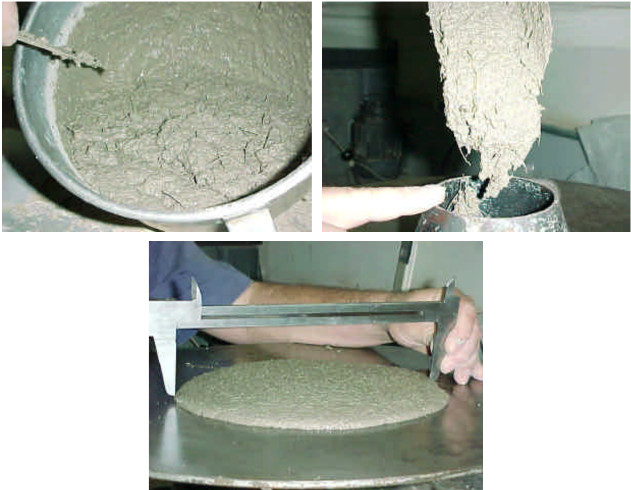
Figura 3.6: Consistência da argamassa com 1 % de fibras
