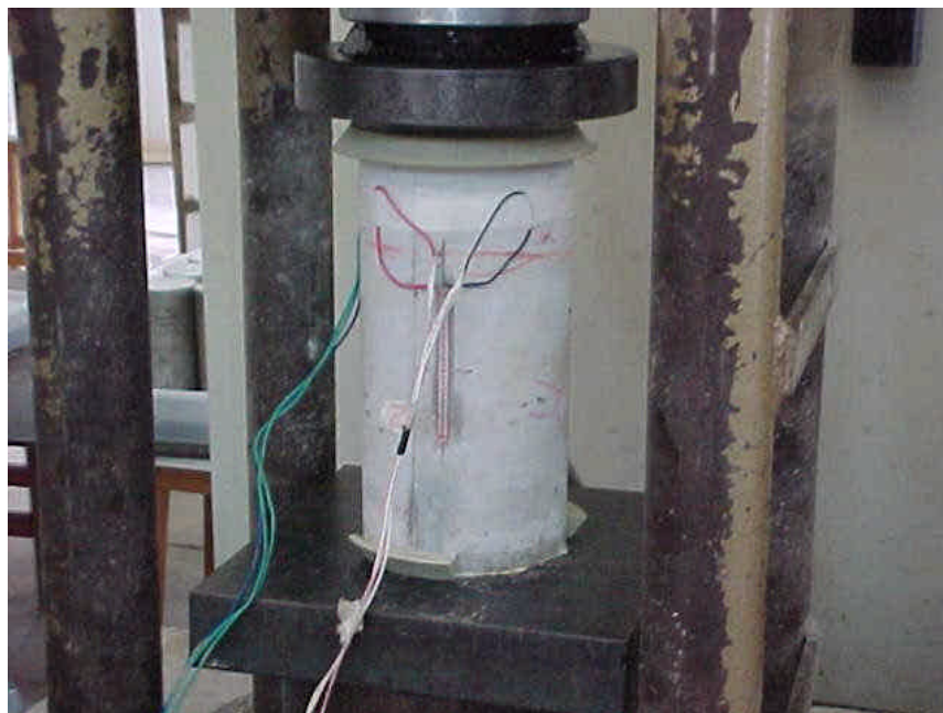
Figura 3.12: Ensaio à compressão axial simples para a determinação do módulo de elasticidade (NBR 8522).
