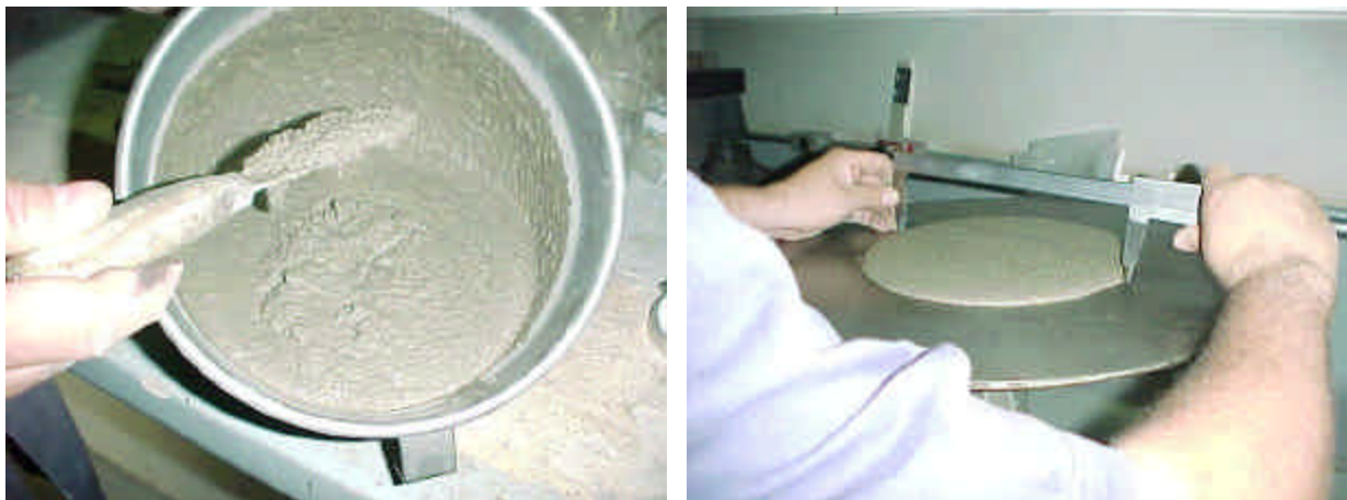
Figura 3.5: Consistência da argamassa com 0 % de fibras.
