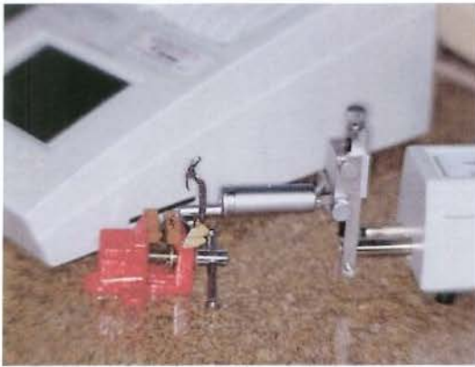
Figura IV-9 – A- Prótese removível adaptada à morsa para leitura no rugosímetro. B- Posicionamento perpendicular da ponta sensora em relação à lâmina metálica fundida
