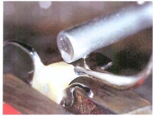
Figura IV-9 – A- Prótese removível adaptada à morsa para leitura no rugosímetro. B- Posicionamento perpendicular da ponta sensora em relação à lâmina metálica fundida
