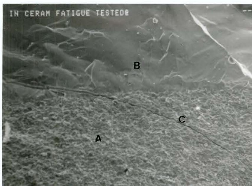
Figura 7 – Imagem em M.E.V. da superfície da cerâmica In Ceram após o teste de fadiga + fratura, com aumento de 246 X; (A) – corpo com alta quantidade de alumina; (B) – cerâmica VITA; (C) - linha de fratura.
