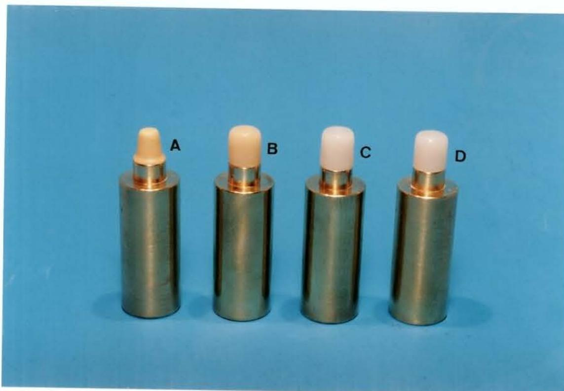
Figura 3 – Corpos-de-prova das cerâmicas: (A) – Corpo In Ceram; (B) – In Ceram completa; (C) - IPS Empress; e, (D) – OPC™.
