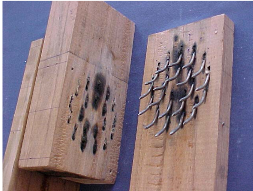
Figura 5.12: Foto de um corpo de prova da ligação com 20 pregos de 2,7mm por face após o ensaio.
