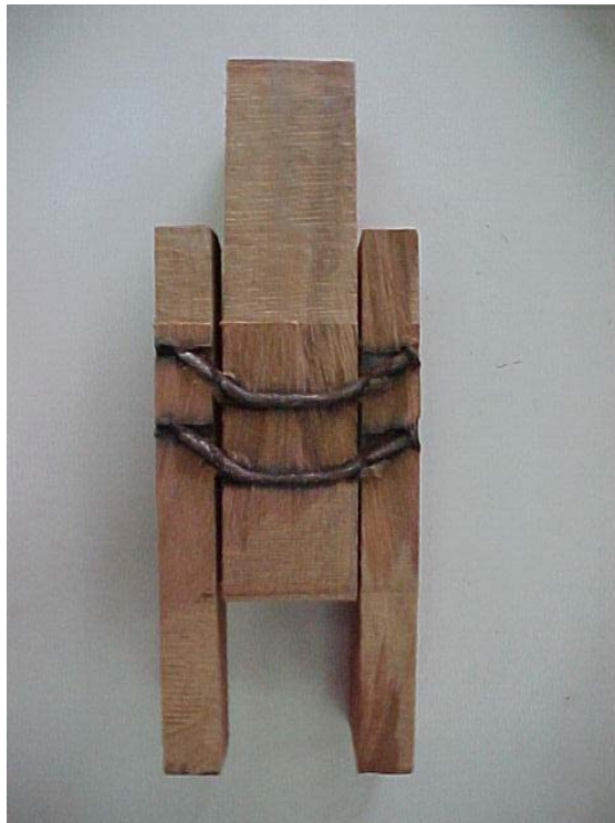
Figura 5.13: Foto de um corpo de prova da ligação com 6 pregos de 4,4mm ensaiado e serrado mostrando a forma deformada dos pregos.
