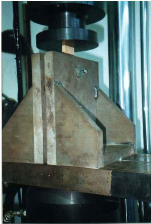
Figura 5.2: Foto da aparelhagem para ensaio de embutimento.
