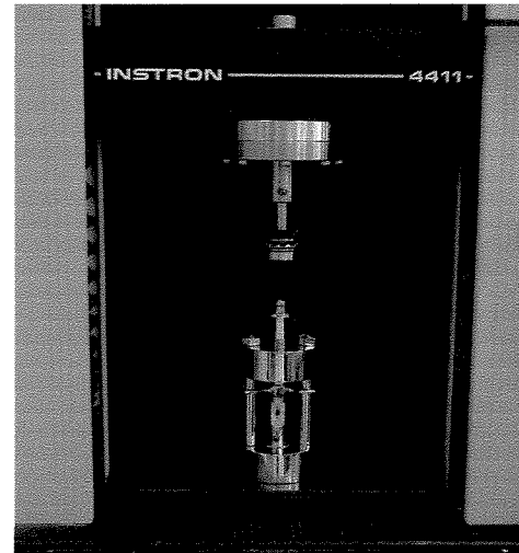
FIGURA 13 - Máquina de Ensaio Universal (Instron) com o dispositivo para ensaio de microtração.
