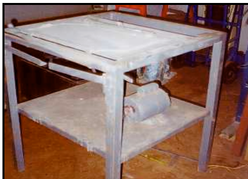
7a) Mesa vibratória para telhas adaptada.
