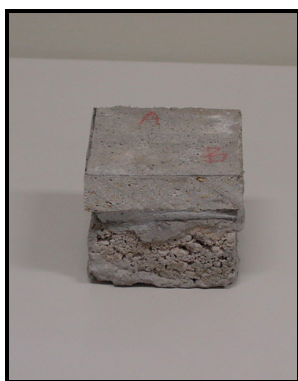
16a) piso colado ao bloco.
