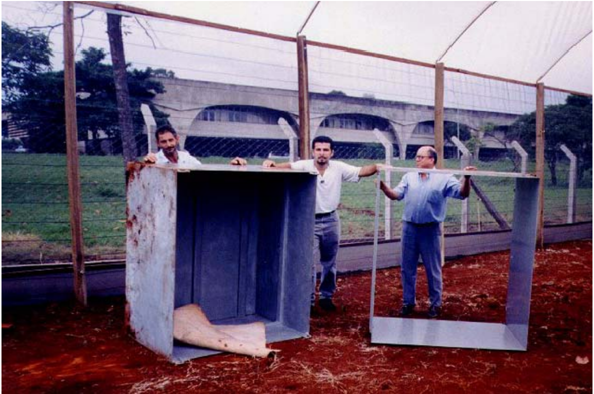
FIGURA 2: Tanques interno e externo utilizados na montagem dos lisímetros
