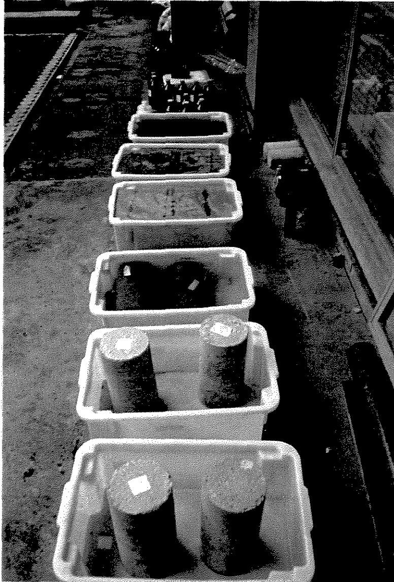
FIGURA 4.19 Amostras submetidas a ataque de ácidos, sendo as duas inferiores testemunhos.
