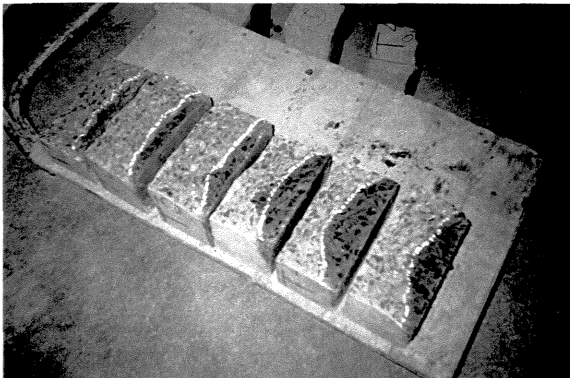
FIGURA 4.16 Mapeamento da Altura da Percolação de Água em Corpo de Prova Submetido à Ensaio de Penetração de Água sob Pressão ( NBR 10787/94 )
