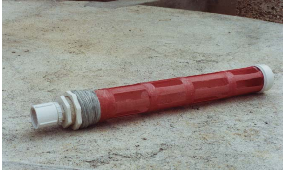
Figura 2. Filtro utilizado para reter partículas sólidas presentes no tanque de equalização.
